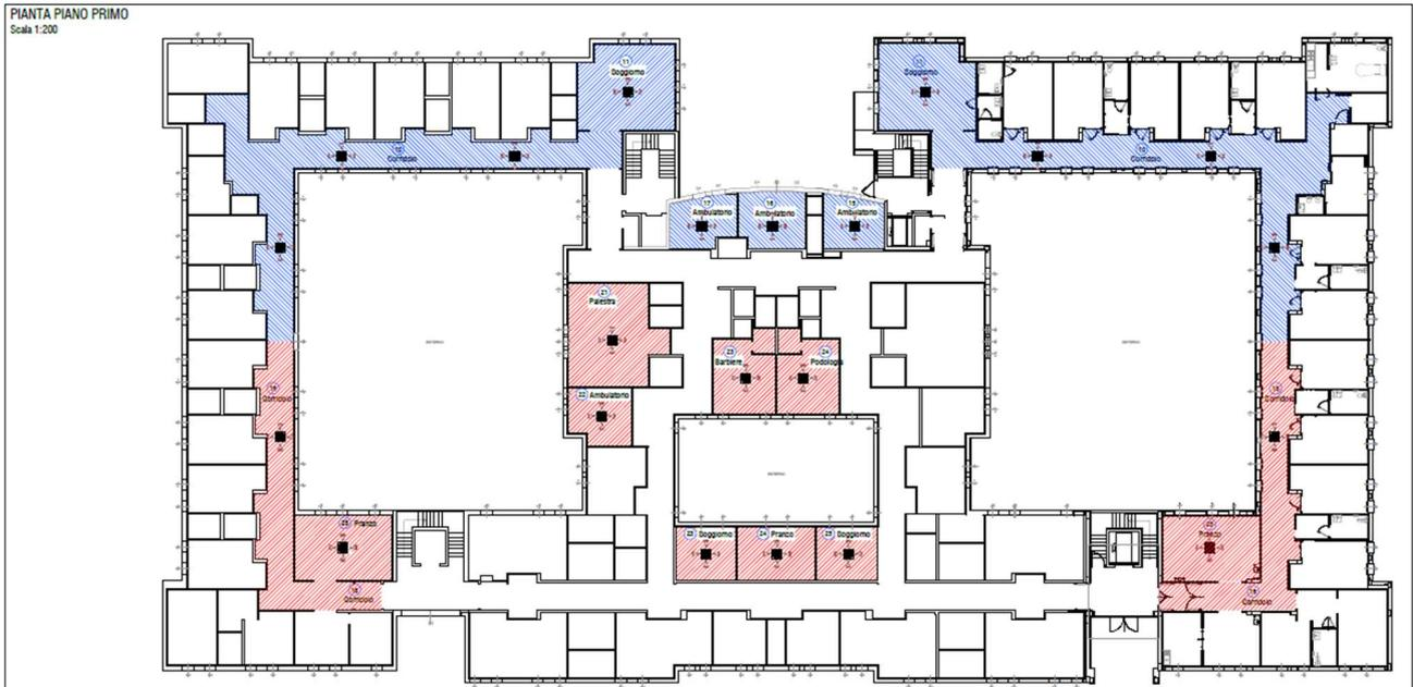
Gli impianti di condizionamenti previsti sono del tipo **VRF (Variable Refrigerant Flow)**, ovvero impianti ad espansione diretta del tipo a portata di refrigerante variabile, con refrigerante R410A.
